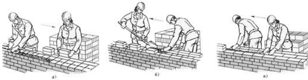
Рисунок 18- Кладка стены толщиной звеном "двойка":
