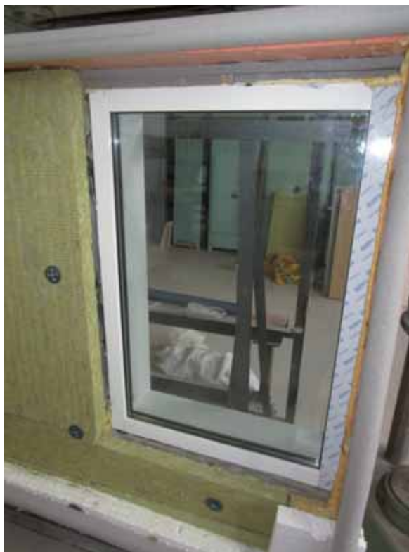
Рис.3.1.8. Изображение испытуемой модели (Расхождение граней в стыке между блоками, с разрушением связующего клеевого состава, прямоугольной формы, толщиной 10 мм, высота 140 мм, глубина 190 мм. Наличие в пенном шве пустот в количестве 2шт, габаритными размерами 80x30x140 мм.) утеплитель 50 мм. до помещения в камеру.
