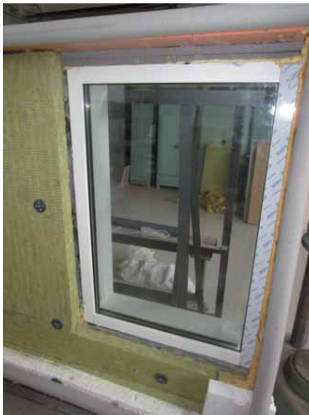
Рис.3.1.16. Изображение испытуемой модели утеплитель 50 мм. до помещения в камеру.
