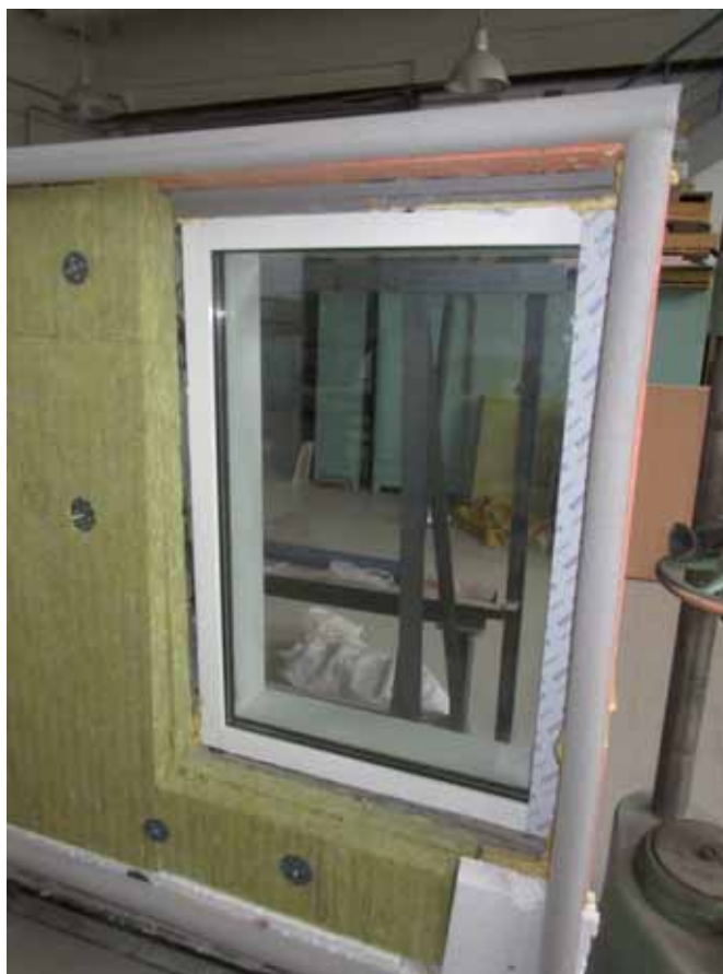
Рис.3.1.11. Изображение испытуемой модели (Расхождение граней в стыке между блоками, с разрушением связующего клеевого состава, прямоугольной формы, толщиной 10 мм, высота 140 мм, глубина 190 мм. Наличие в пенном шве пустот в количестве 2шт, габаритными размерами 80х30х140 мм.) утеплитель 100 мм. до помещения в камеру.
