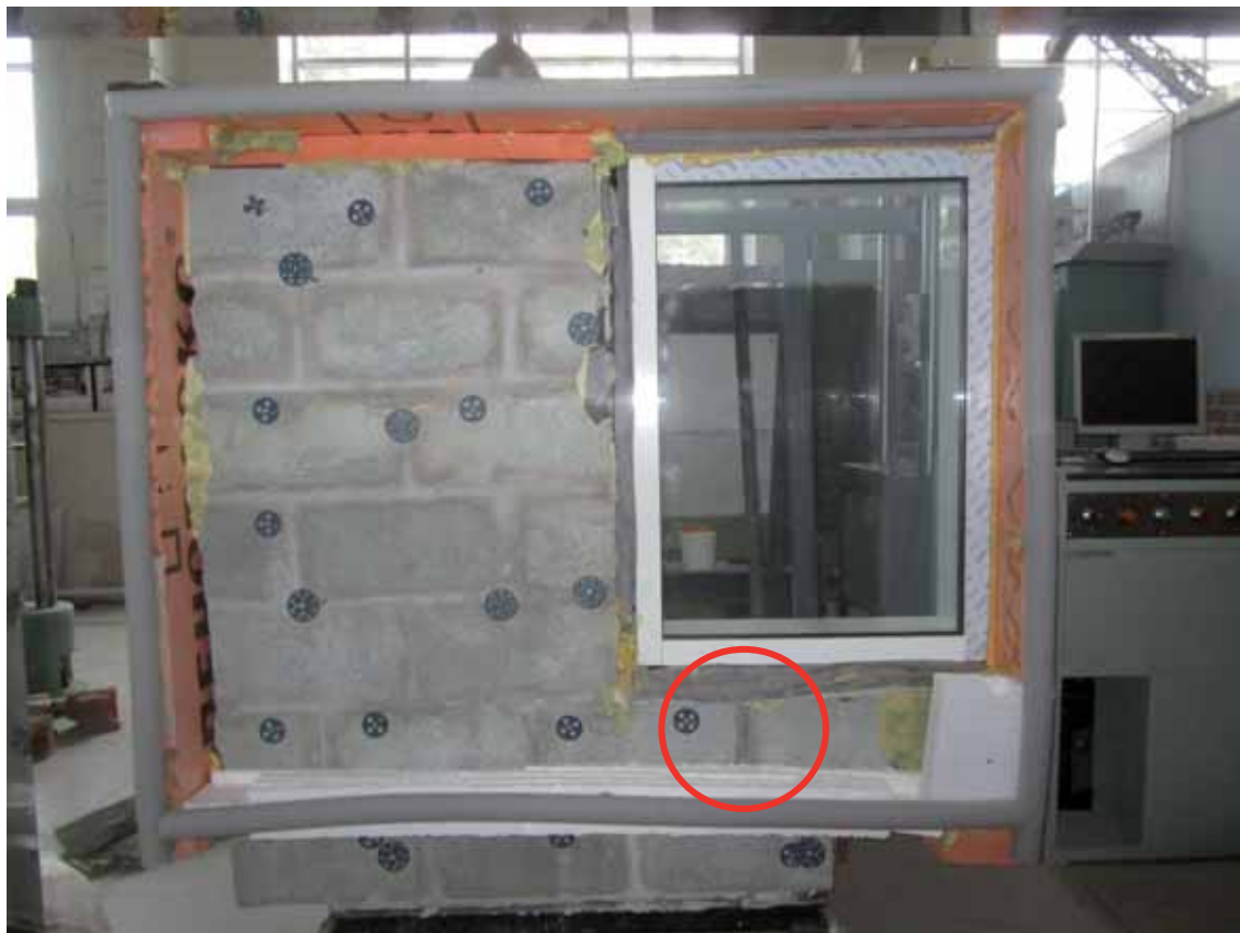
Рис.3.1.4. Изображение испытываемой модели (Расхождение граней в стыке между блоками, с разрушением связующего клеевого состава, прямоугольной формы, толщиной 10 мм, высота 140 мм, глубина 190 мм.) до помещения в камеру.
