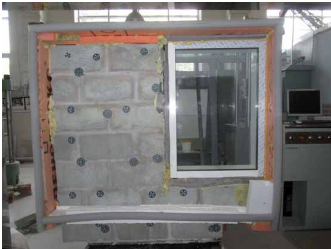
Рис.2.3. Исследуемая модель, помещаемая в климатическую камеру
