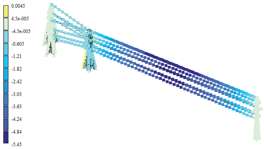
Рисунок 4.6 - Вертикальные перемещения участка ЛЭП в (м): а – в ПК ANSYS; б – в ПК Ли́ра-САПР
