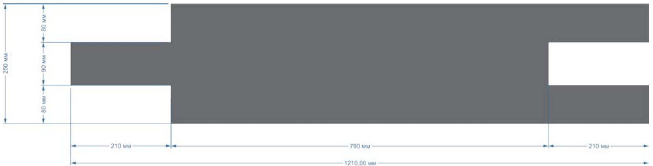
Рисунок 54 – Модель улучшенного блока по технологии Теколит (вид сбоку)
