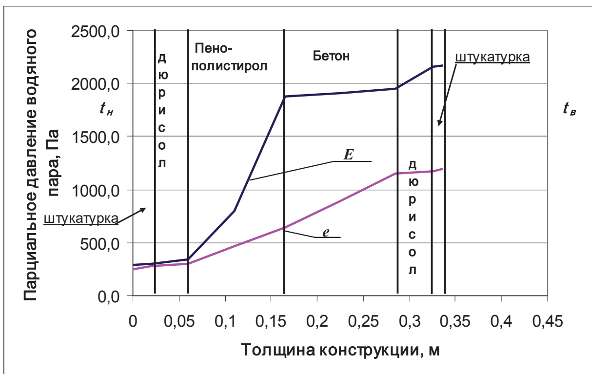
Рисунок 11- Распределение фактической и максимальной упругостей водяного пара в толще рассчитываемой конструкции при средней месячной температуре наружного воздуха -10,2^{\circ}\text{C} .
