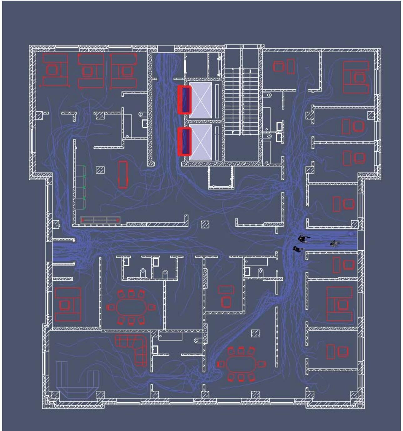
Рисунок 2.13 — Расположение людей и схема их движения через 50 секунд
