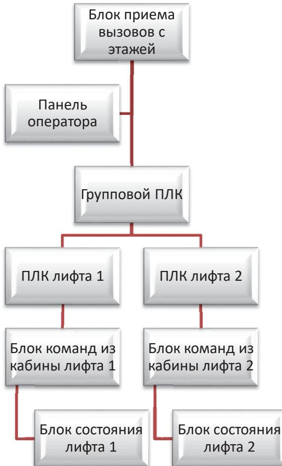
Рисунок 3.1 — Обобщённая структурная схема разрабатываемой системы.
