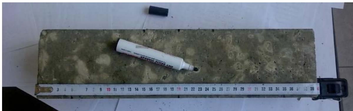
Рисунок 12. Снятие линейных размеров и разметка образца.
