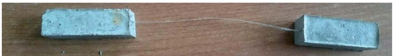
Рисунок 21. Образец для испытания фибры на прочность.
