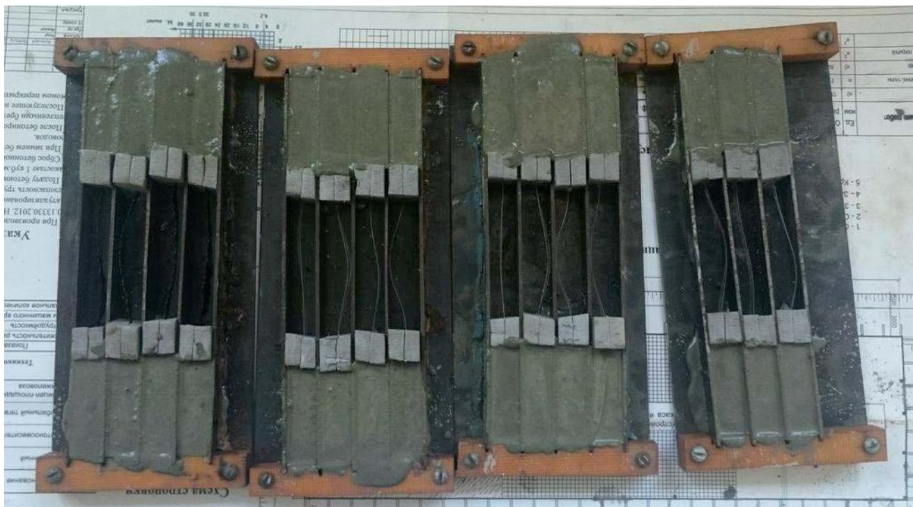
Рисунок 20. Залитые формы образцов для испытания фибры на прочность.
