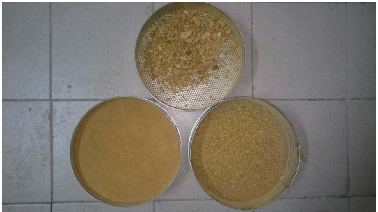
Рисунок 9. Просеивание песка.
