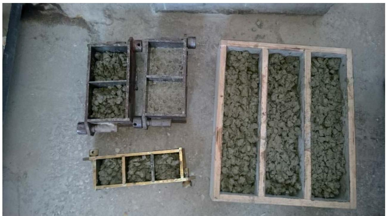
Рисунок 10. Формы для заливки образцов.
