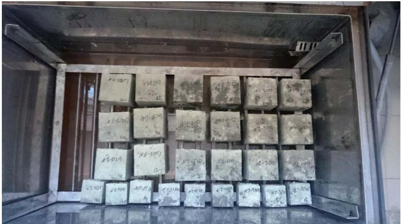
Рисунок 11. Хранение образцов в камере нормального твердения.
