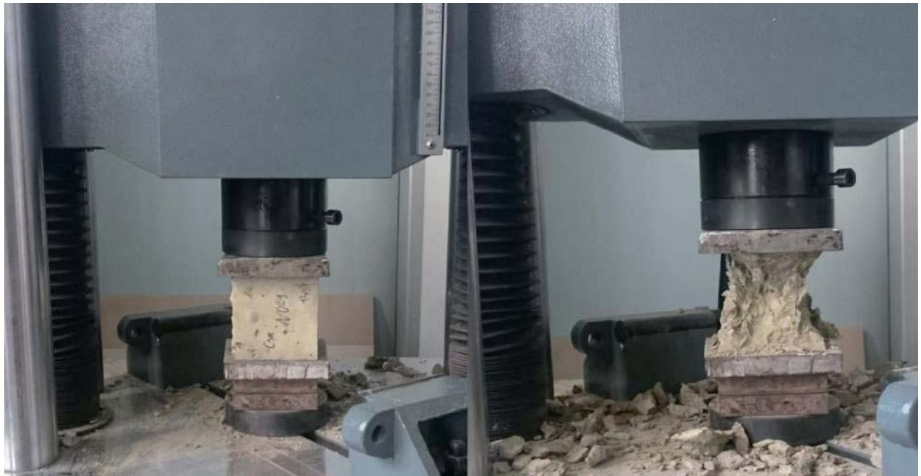
Рисунок 15. Испытание образцов кубов 100x100x100.
