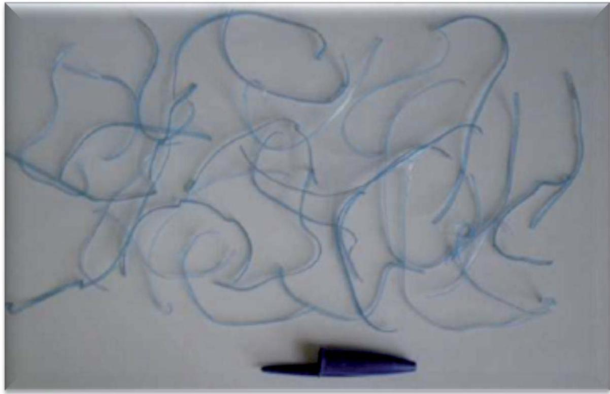
**Рисунок 3. Волокна, полученные из отходов ПЭТ-бутылок. Польша.**
