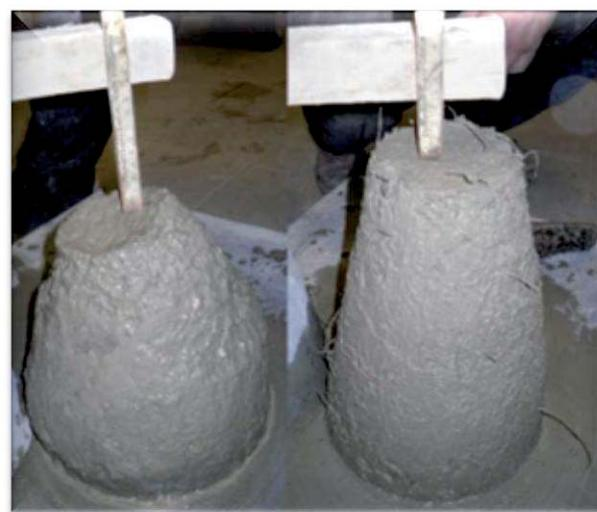
**Рисунок 4. Испытание на осадку конуса бетонной смеси без волокон ПЭТ (слева) и 0,1% (по объему) волокна ПЭТ (справа). Польша.**
