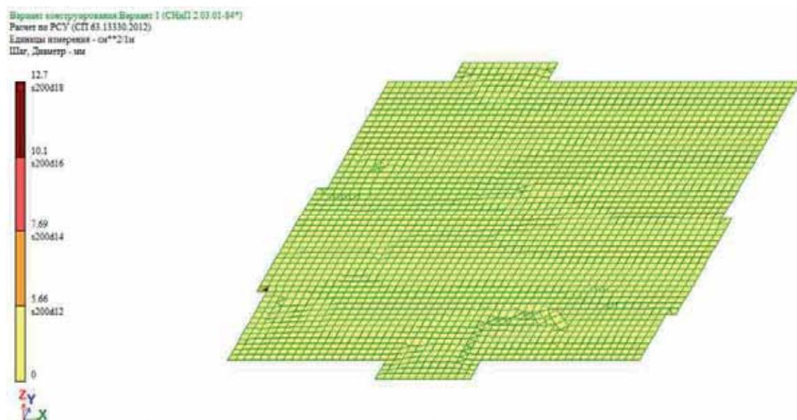
Рис. 3.8.2 Площадь арматуры на 1 п.м по оси Y, X у нижней грани
