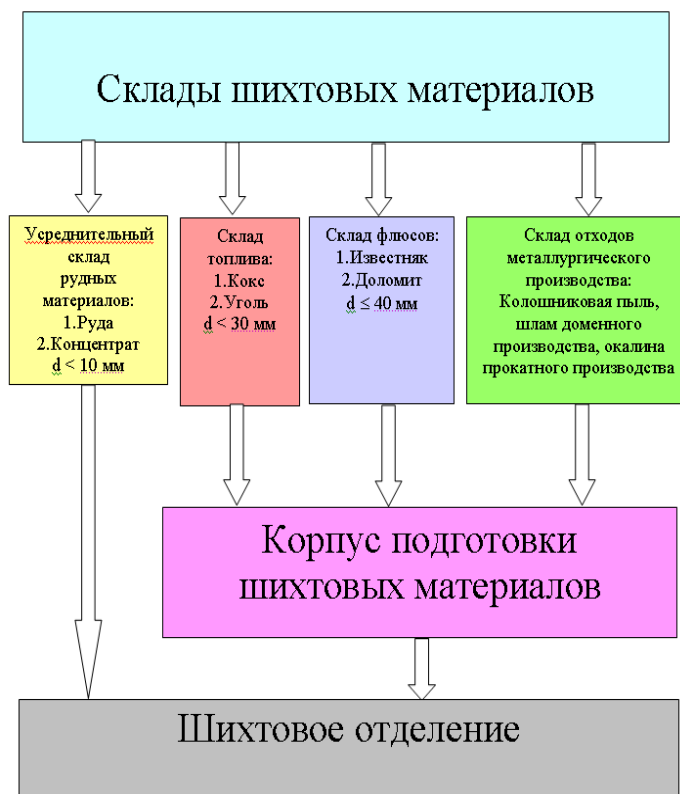
Рисунок 4. Структура складов для шихтовых материалов агломерационной фабрики
