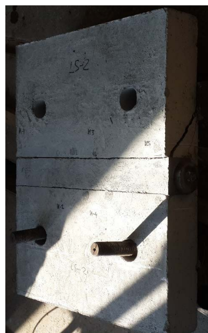
Рисунок 3.7 – Фото образца типа LS120 после испытания
