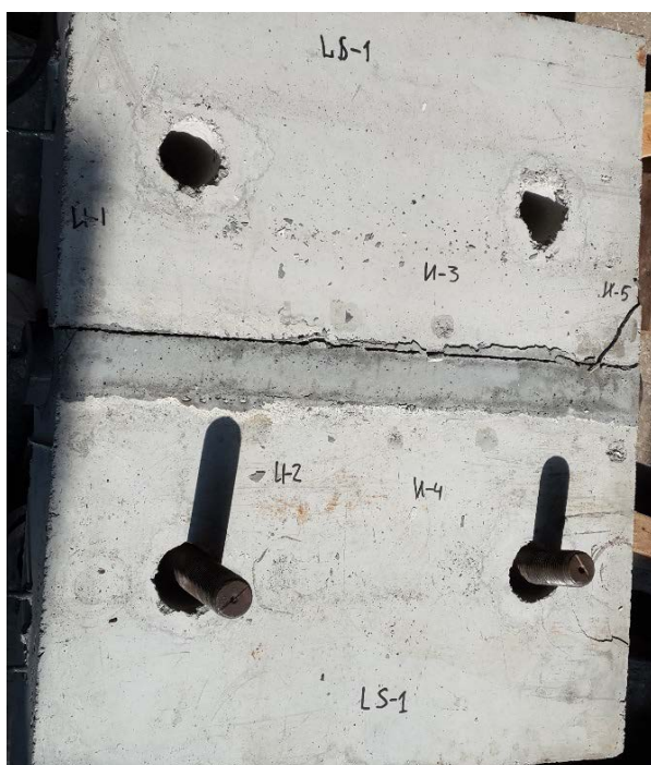
Рисунок 3.7 – Фото образца типа LS120 после испытания
