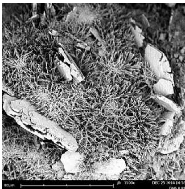
Рисунок 7 – Микроструктура с добавкой с добавкой дисперсии микрокремнезема (8 % от массы портландцемента)
