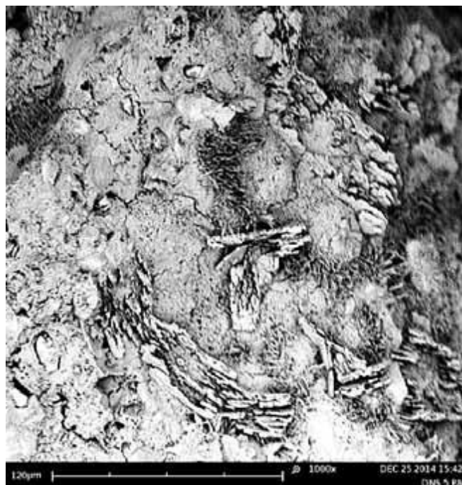
Рисунок 6 – Микроструктура цементного камня с добавкой дисперсии микрокремнезема (5 % от массы портландцемента)
