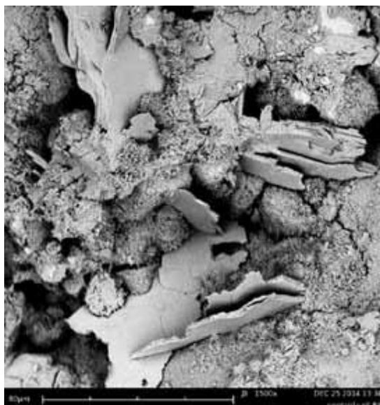
Рисунок 3 – Макроструктура цементной матрицы с кристаллами гидроксида кальция (при 1500-кратномувеличении)
