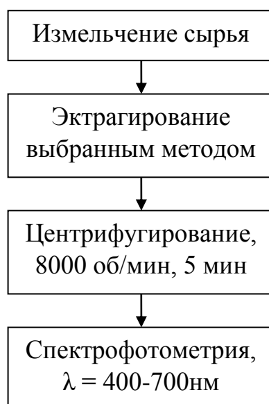
Рисунок 3.2 – Схема определения беталаиновых пигментов в сырье свеклы столовой ( Beta vulgaris L.)
