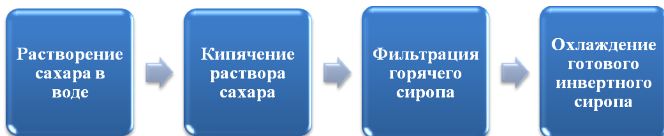
Рисунок 2.2.1 – Схема производства инвертного сиропа на ООО ПТК «Колос»
