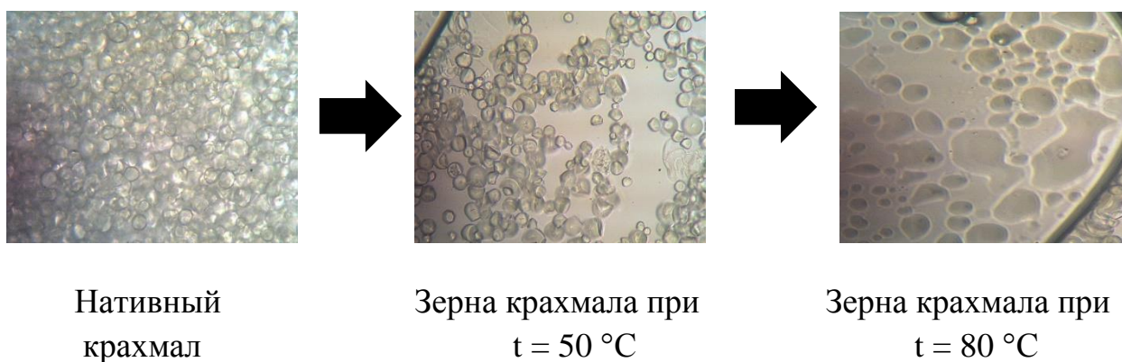
Рисунок 21 – Схема технологических изменений тапиоковых крахмальных зерен при нагревании
