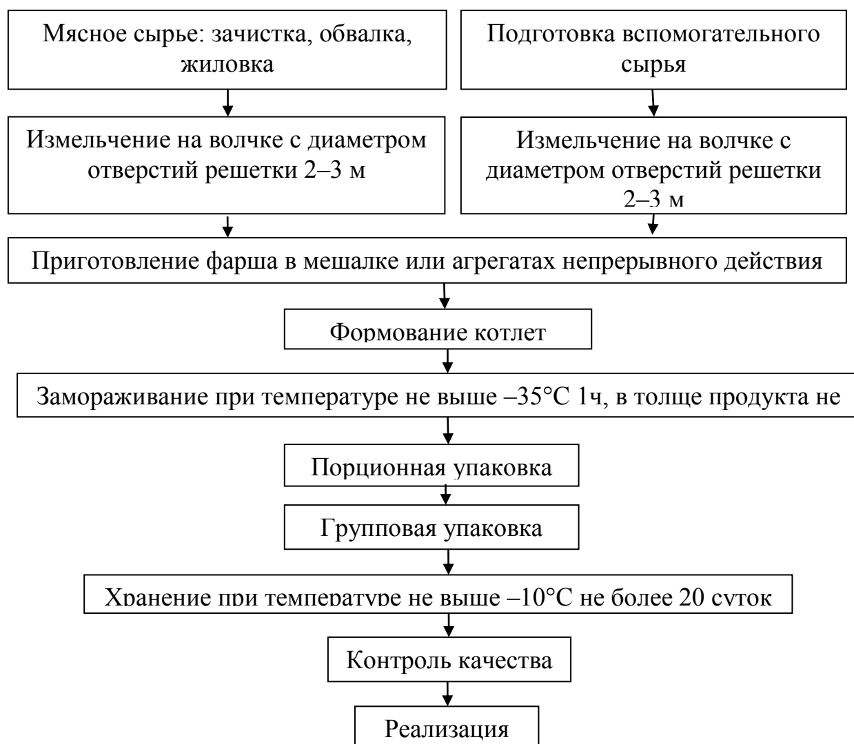
Рисунок 1 – Технологическая схема производства рубленых полуфабрикатов
