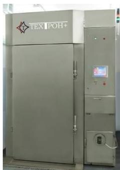
Рисунок 6 – Автоматическая коптильно-варочная термокамера Т-400Е
