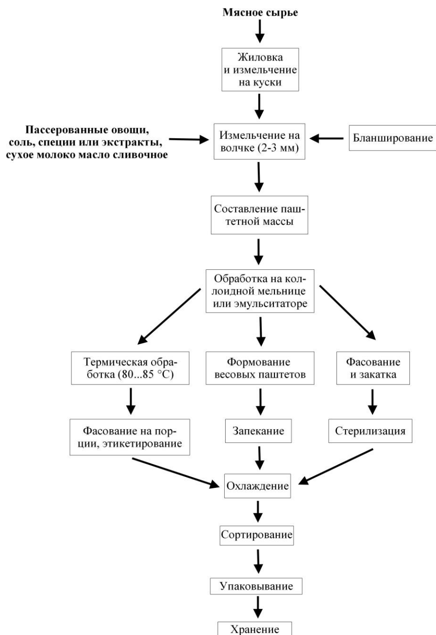
Рисунок 4 – Технологический процесс производства паштетов [13]
