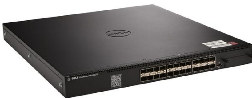
Рисунок 5 - Коммутатор Dell PowerConnect 8132F
