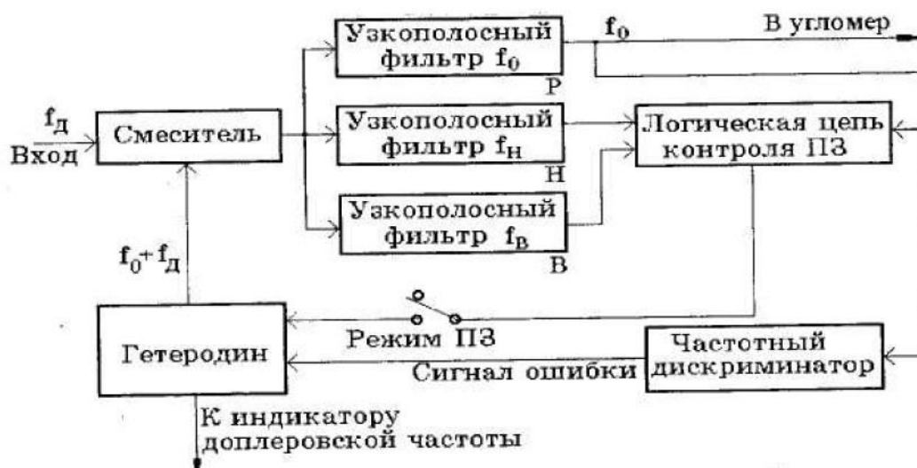
Рисунок 4.7 - Структурная схема устройства защиты со сторожевыми стробами по скорости
