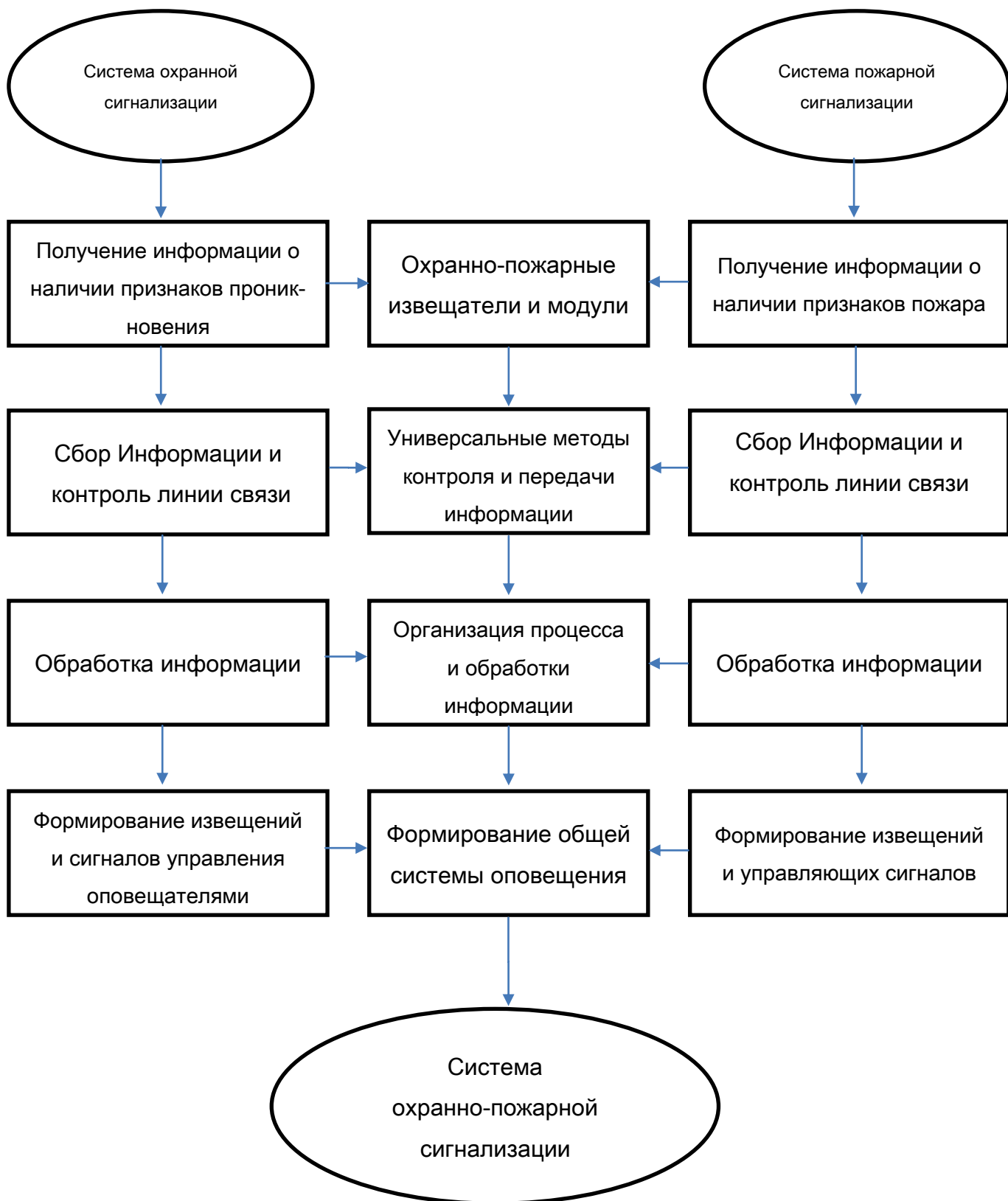
Рисунок 3 – Обобщенная схема интеграции систем охранной и пожарной сигнализации
