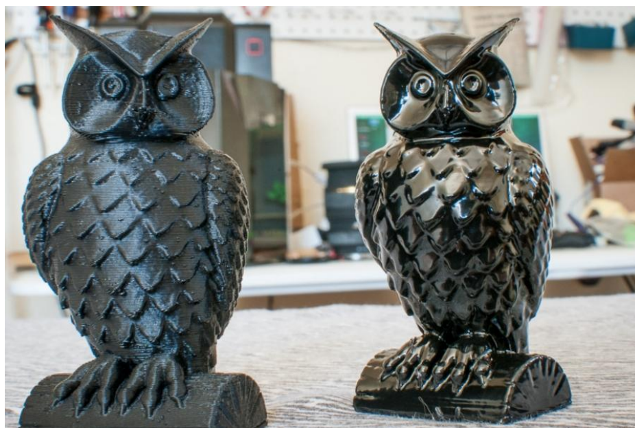
Рисунок 4.6 – Изделие, обработанное ацетоном
