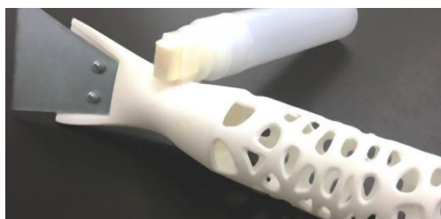
Рисунок 4.7 – Устройство для ручной химической обработки Makeraser
