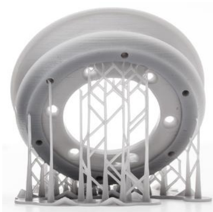
Рисунок 2.4 – "Подпорки" при печати FDM-технологией
