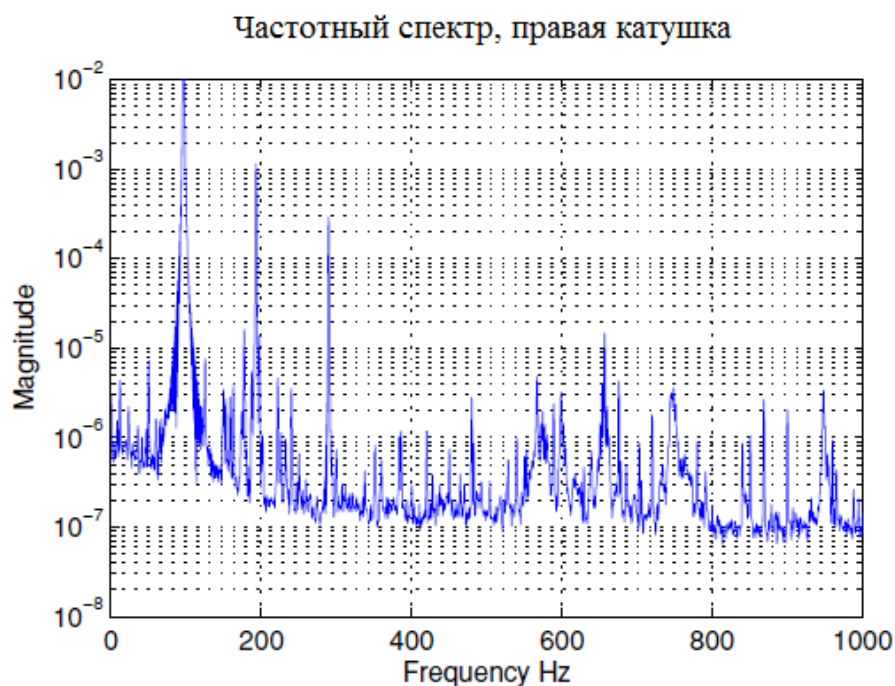
Рисунок 4.2 – Спектр сигнала катушек с 0 объемом содержания воздуха и расходом 0,3 кг/с
