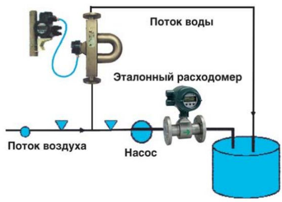
Рисунок 2.5 – Установка для испытания кориолисового расходомер
