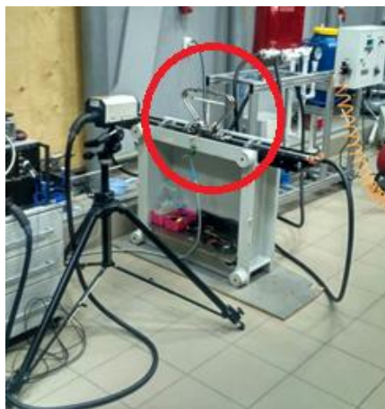
Рисунок 2.20 – Отображение расходомера в закреплённом состоянии
