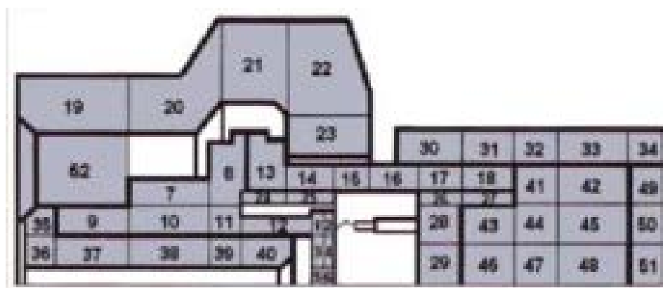
Рисунок 1.7 - Тепловая модель с разбиением на элементарные объемы датчика давления:
