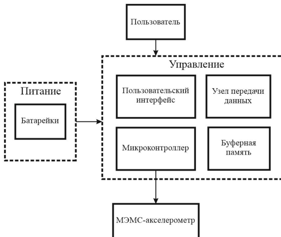
Рисунок 4.1 – Структурная схема проектируемого инклинометра
