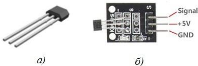
Рисунок 2.4 – Датчик холла: а) внешний вид датчика; б) его исполнение на микросхеме
