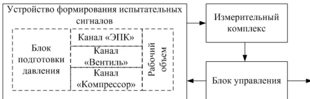
Рисунок 3.3 – Структурная схема стенда
