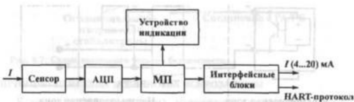
Рисунок 1.1 – Функциональная схема цифрового средства измерения
