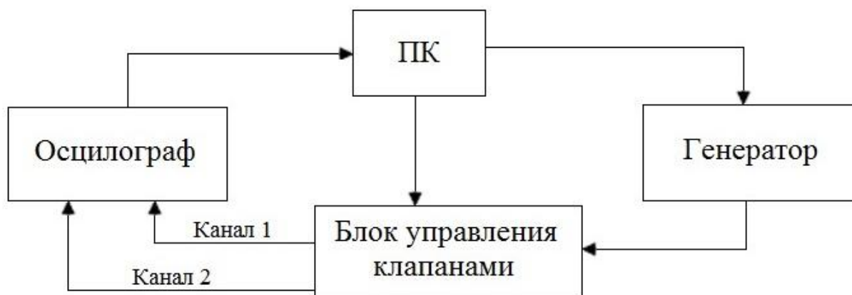
Рисунок 3.17 – Схема подключения стенда
