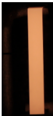
Рисунок 3.8 – Изображение ленты накаливания эталонной лампы
