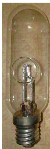
Рисунок 3.4 – Конструкция эталонной лампы ТРУ 1100-2350 № 117
