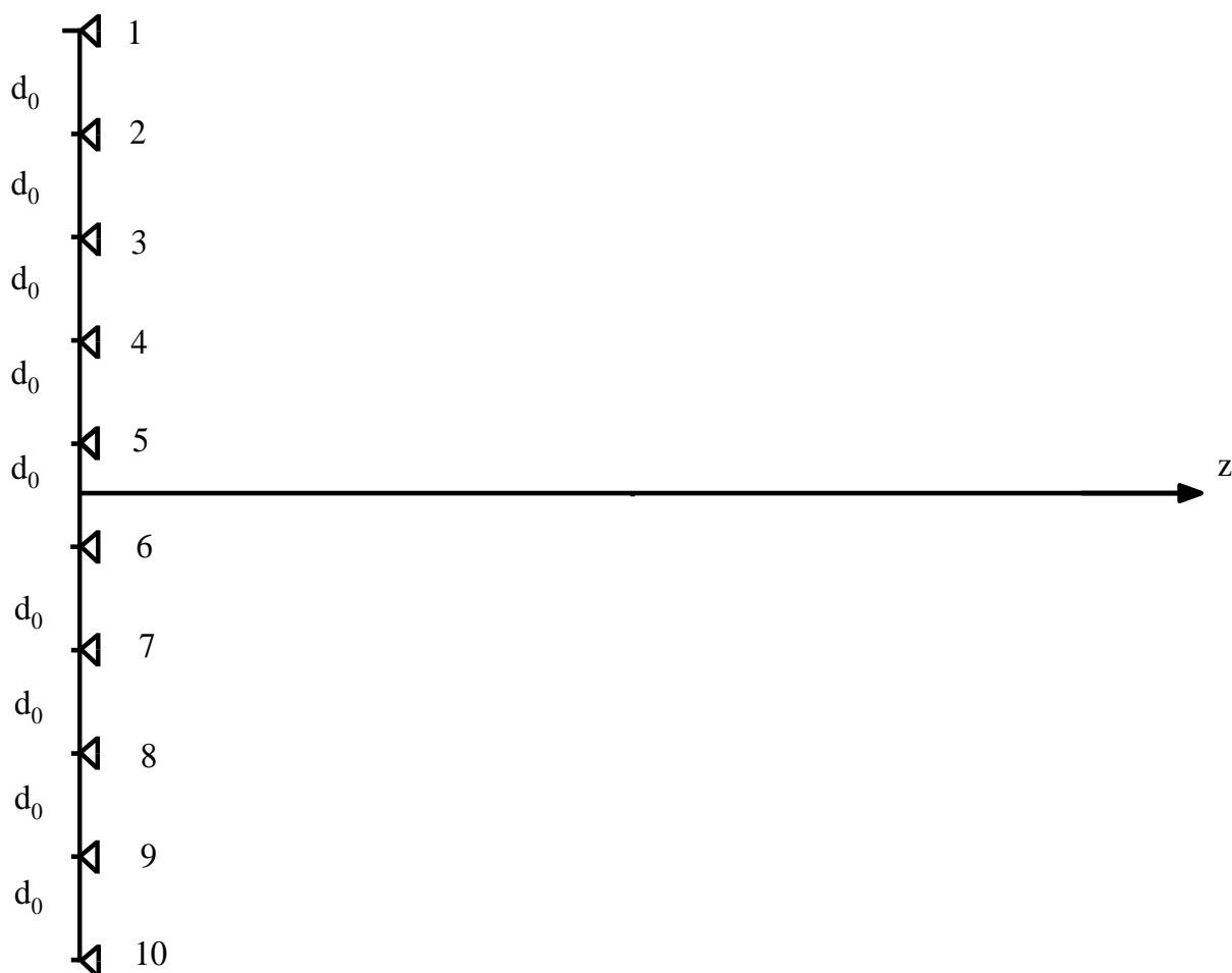
Рисунок 5.9 – Эквидистантная антенная решётка с 10 излучателями
