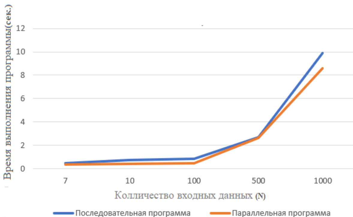
Рис. 6. График зависимости времени выполнения последовательной и параллельных программ от количества входных данных методом прогонки
