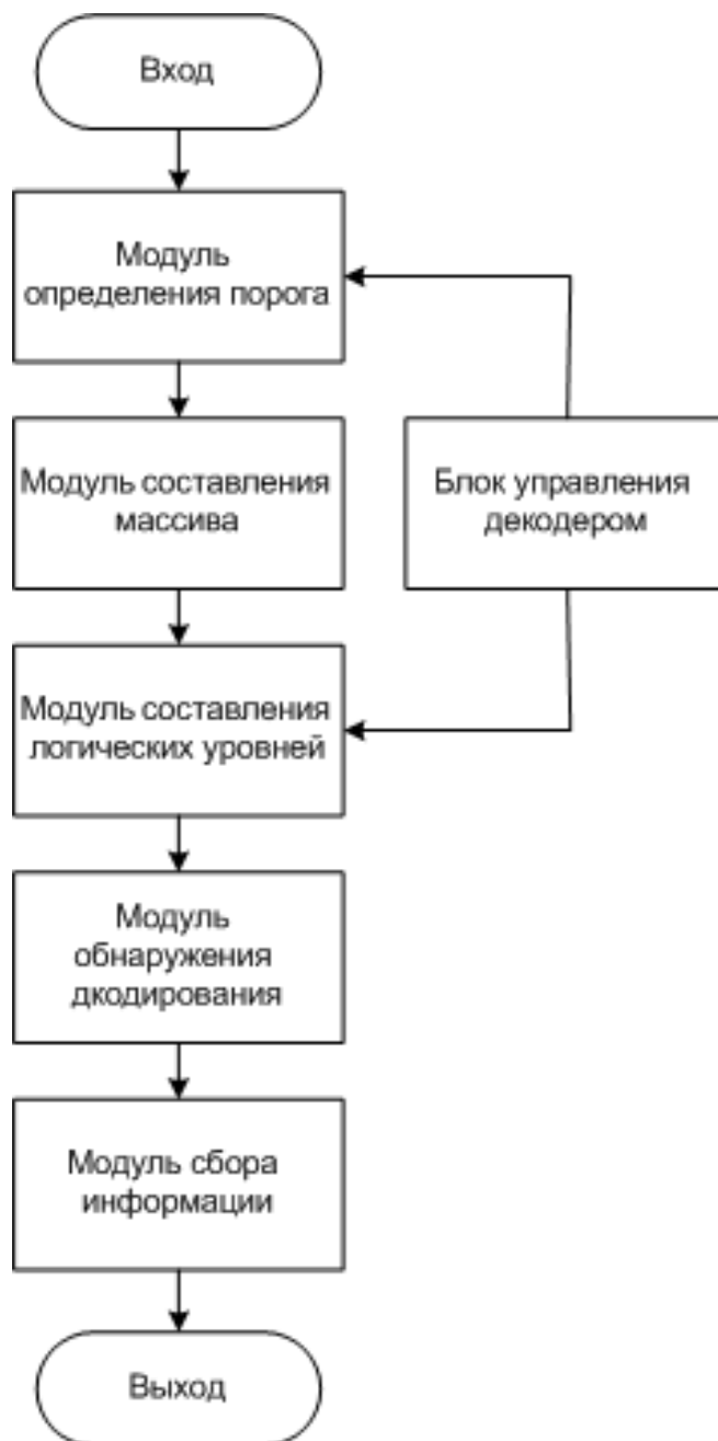
Рисунок 3.37 – Блок схема программы ПЛИС
