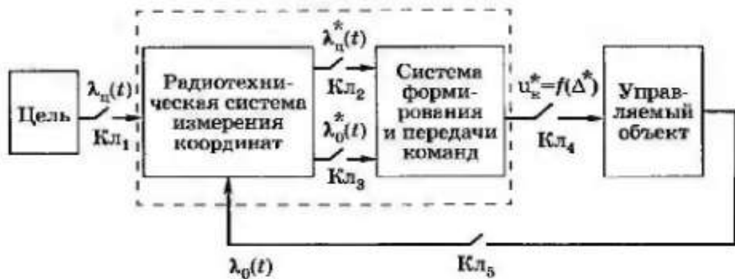
Рисунок 1.3 – Структурная схема системы радиоуправления
