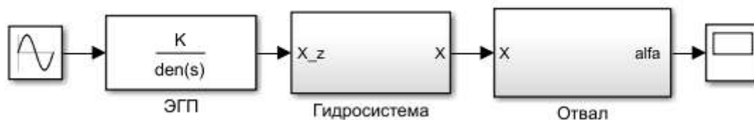
Рисунок 3.4 – Структурная схема объединённой модели в среде Simulink
