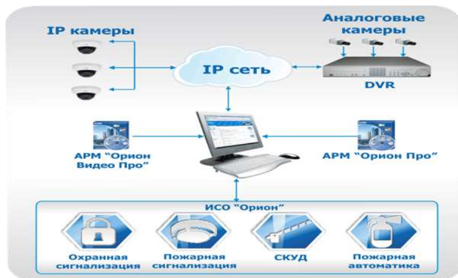
Рисунок 6.2 – Архитектура СКУД «Орион – Про»
