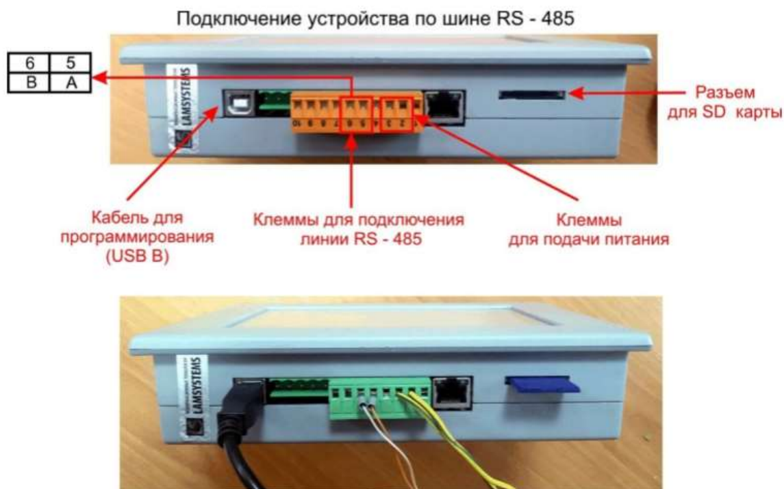
Рисунок 3.23 – Подключение устройства по шине RS– 485
