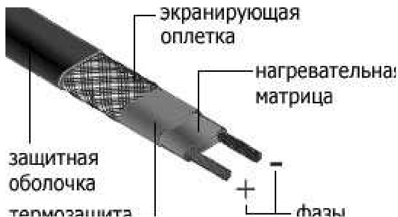
Рисунок 4 – Строение саморегулирующегося кабеля
