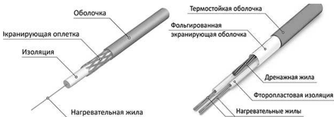
Рисунок 3– Строение одножильного и двухжильного кабеля
