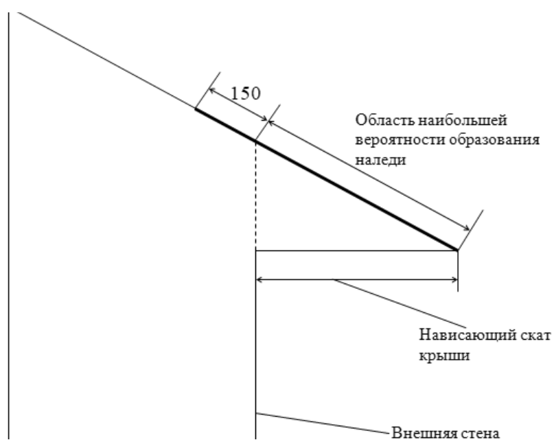
Рисунок 9 – Расположение кабеля на крыше. Вид с торца
