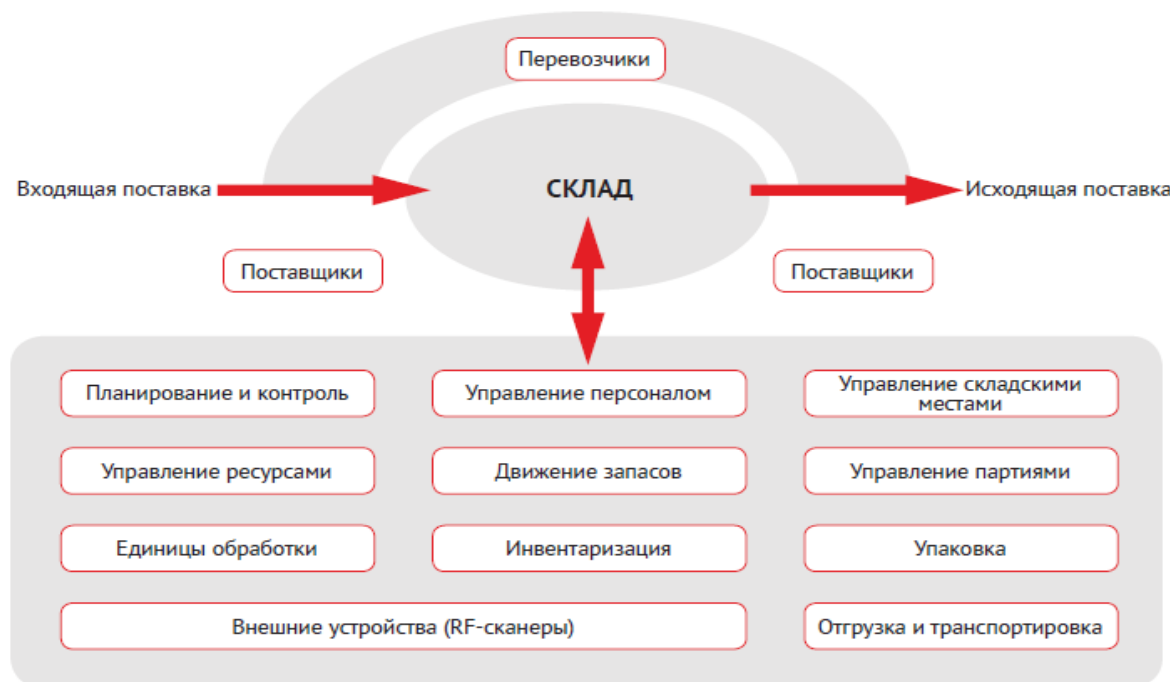
Рисунок 3.3 – Функциональность EWM при автоматизации управления складом
