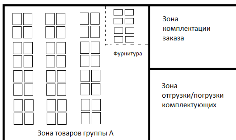
Рисунок 3.12 – Схема склада при адресной системе складирования
