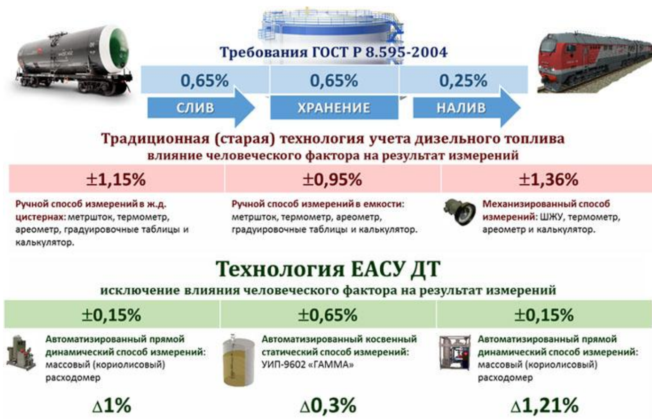
Рис 10. - Сравнение технологий измерений дизельного топлива (значения погрешностей)
