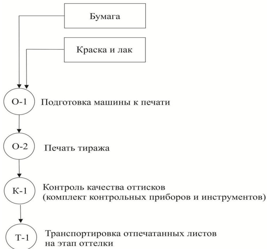
Рисунок Р.3 – Пооперационная карта печатного этапа производства
