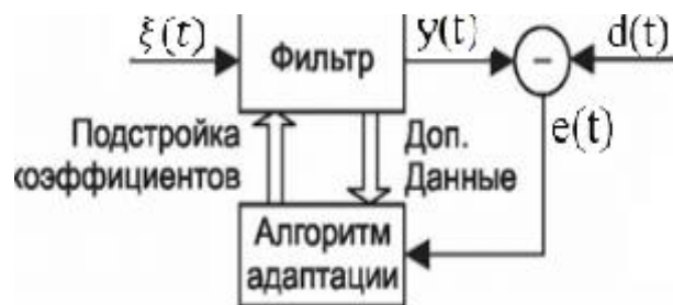
Рисунок 4 – Общая структура адаптивного фильтра.
