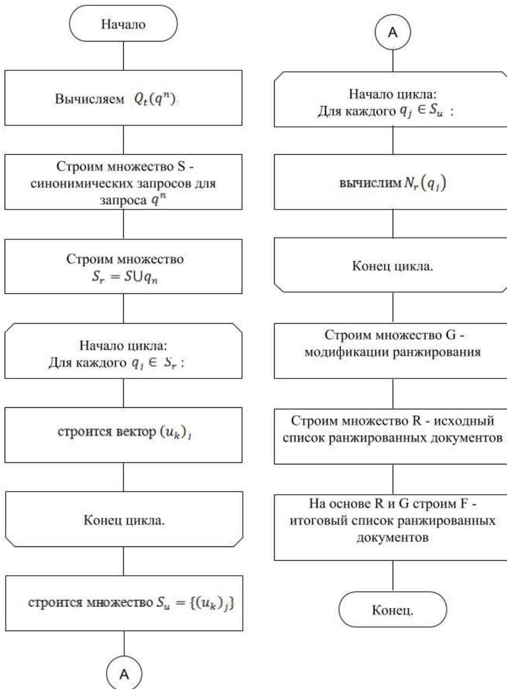
Рисунок 3.2 – Схема алгоритма взаимодействия поисковой системы с тематической моделью
