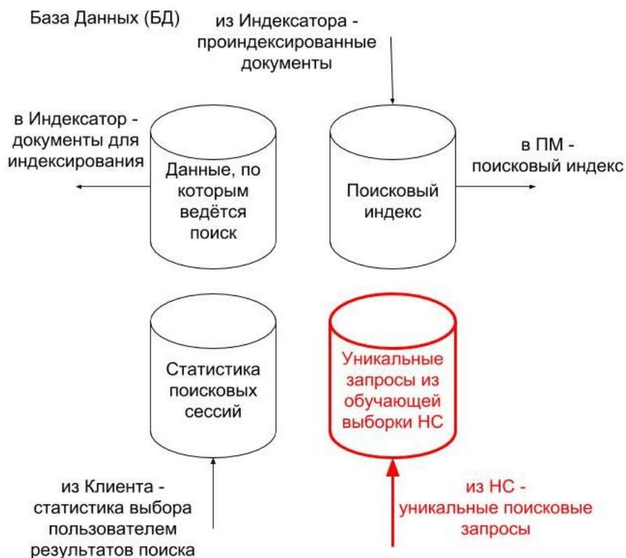
Рисунок 3.3 – Схема взаимодействия с подмодулями модуля База Данных после внедрения в поисковую систему искусственной нейронной сети
