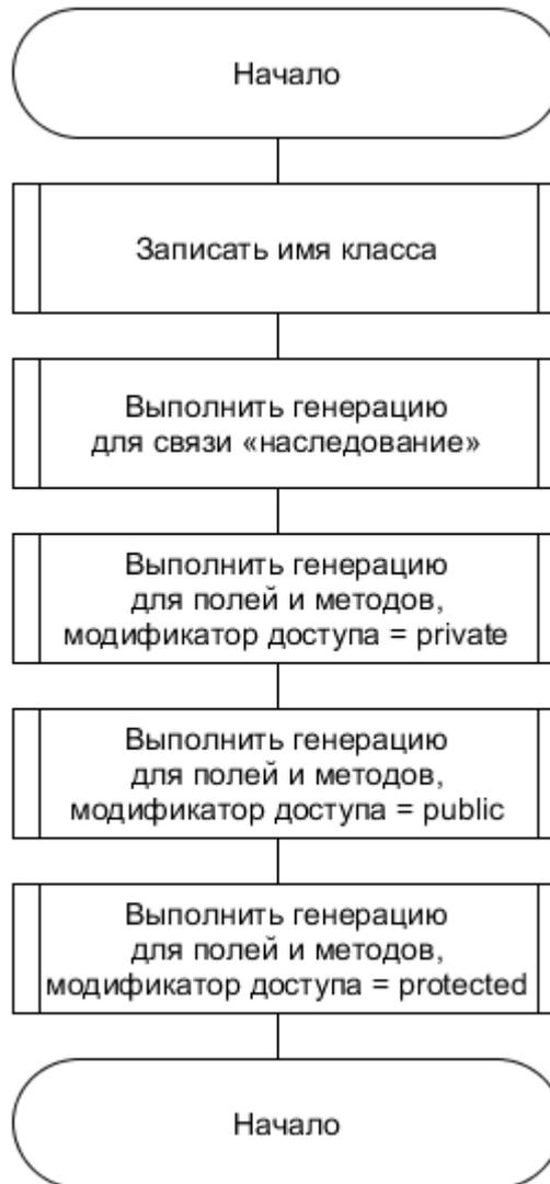
Рисунок 3.7 – Алгоритм генерация кода
