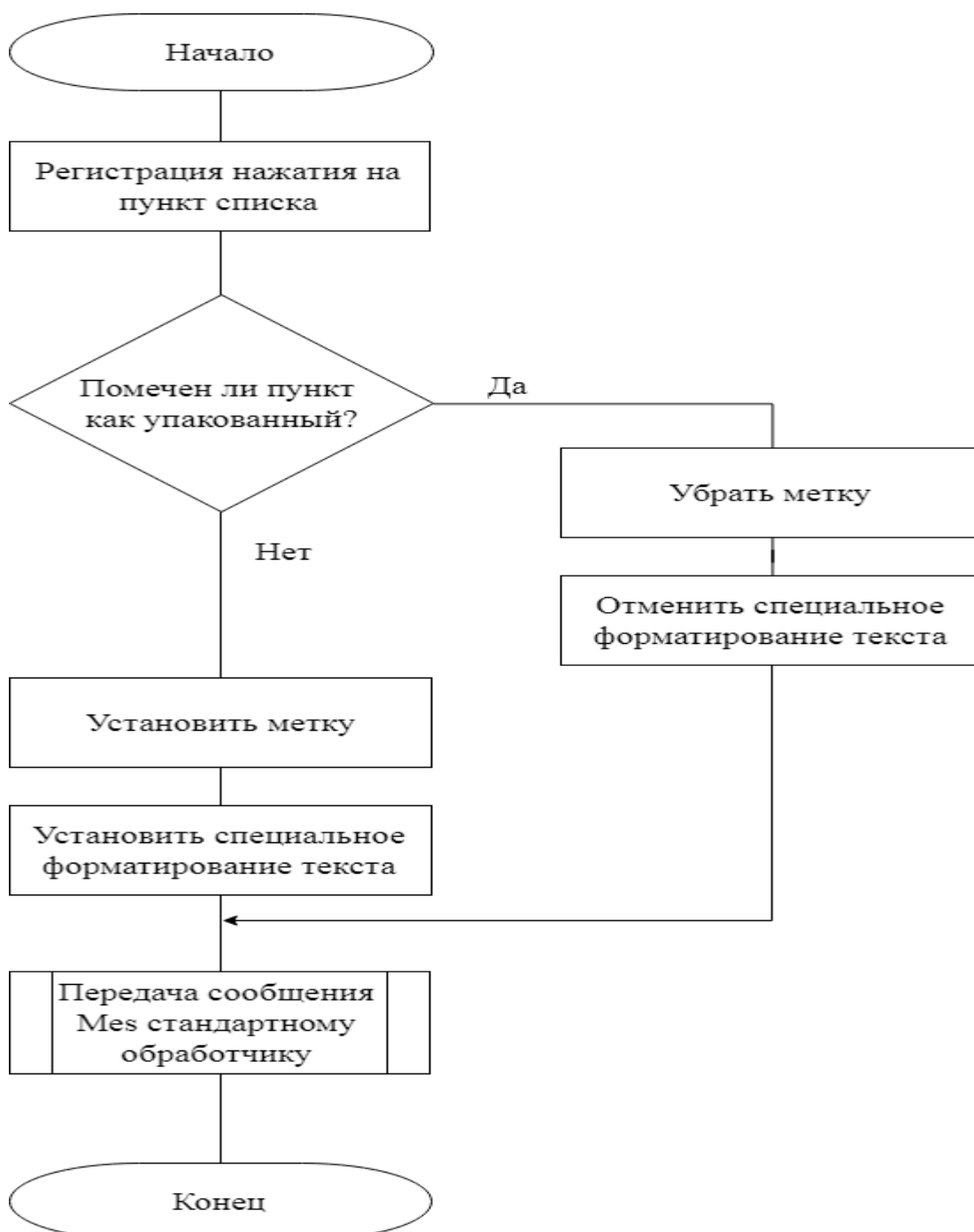
Рисунок 3.5 – Алгоритм обработки нажатий на пункты списка во время его просмотра
