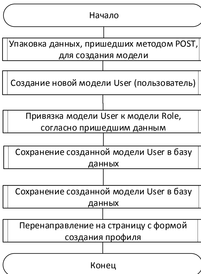
Рисунок 2.18 – Схема алгоритма работы контроллера RegisterController
