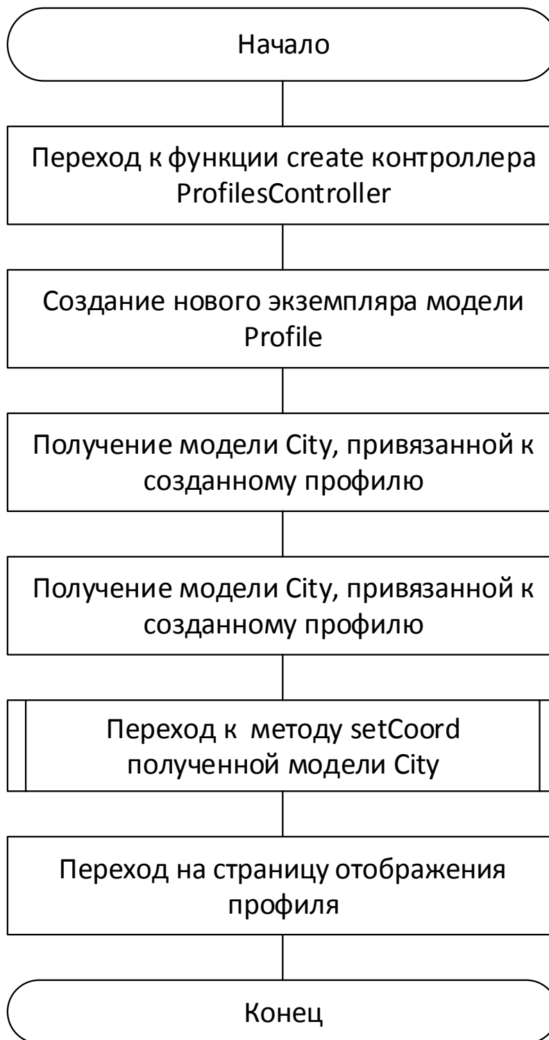
Рисунок 2.19 – Схема алгоритма, запускаемого кнопкой «Продолжить» после заполнения анкеты выпускника
