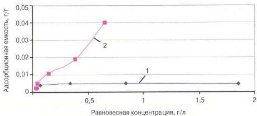
Рисунок 2 – Изотермы адсорбции фенола, обработанного 20 %-ной серной и 80%-ной фосфорной кислотами[15]
