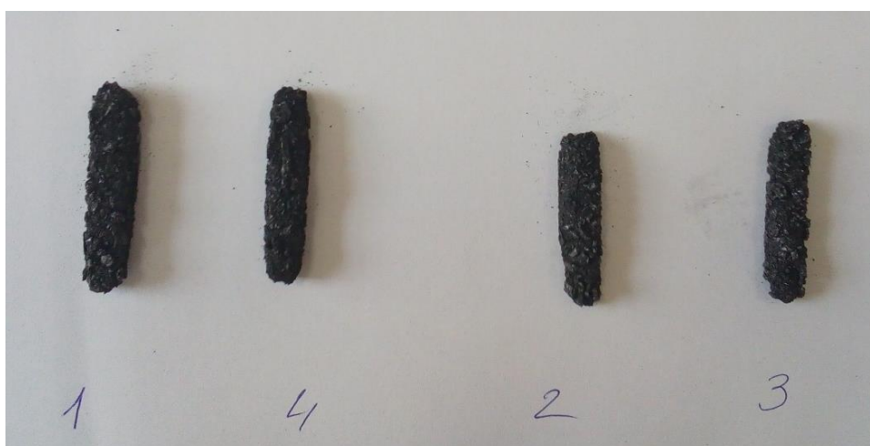
Рисунок 3.7 – Графит после термообработки при 800 °С:
