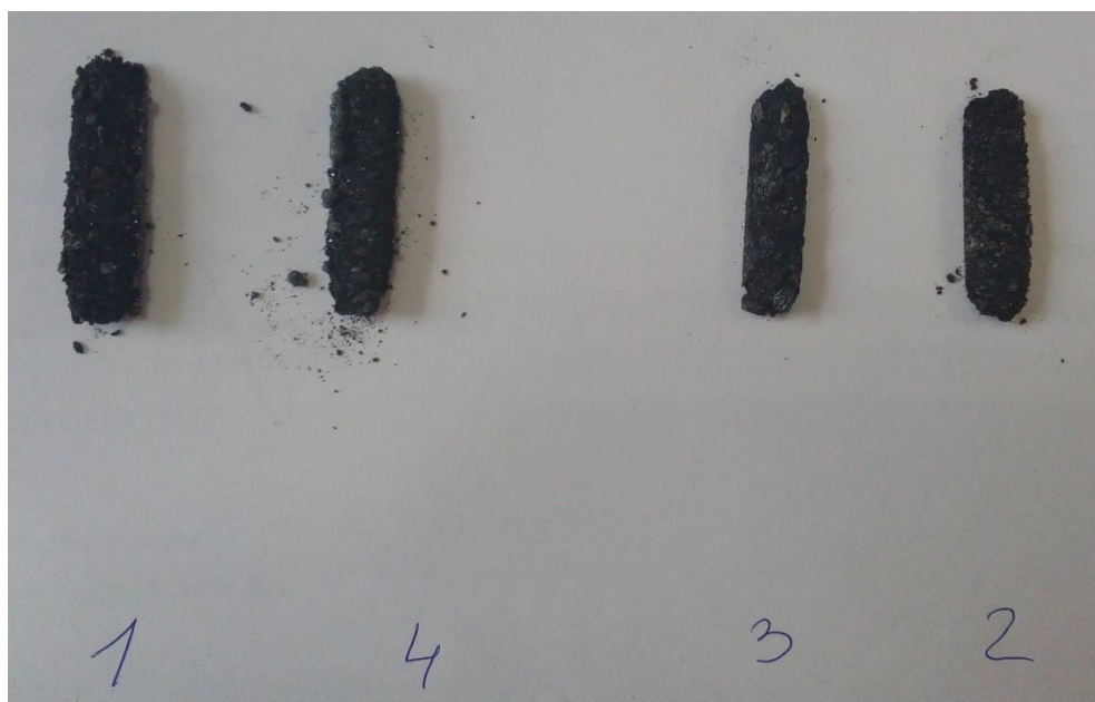
Рисунок 3.8 – Графит после термообработки при 900 °С:
