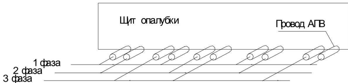
Рисунок 35. Узел крепления греющего провода к троллеи
