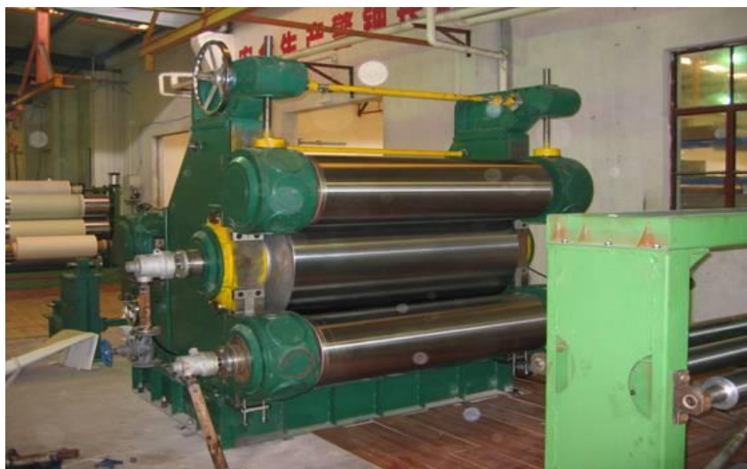
Рисунок 8 - машина непрерывной вулканизации резинового полотна DLG
