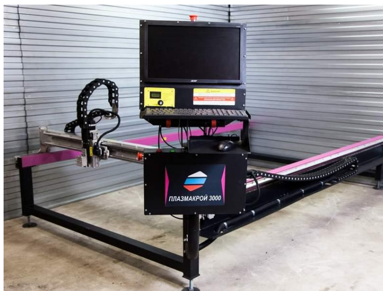
Рисунок 7 - Станок плазменной резки ПЛАЗМАКРОЙ 3000М
