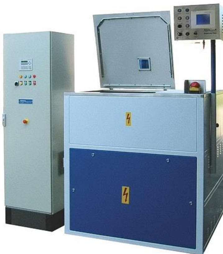
Рисунок 2.25 – Литейная машина Linn SUPERCASST Titan
