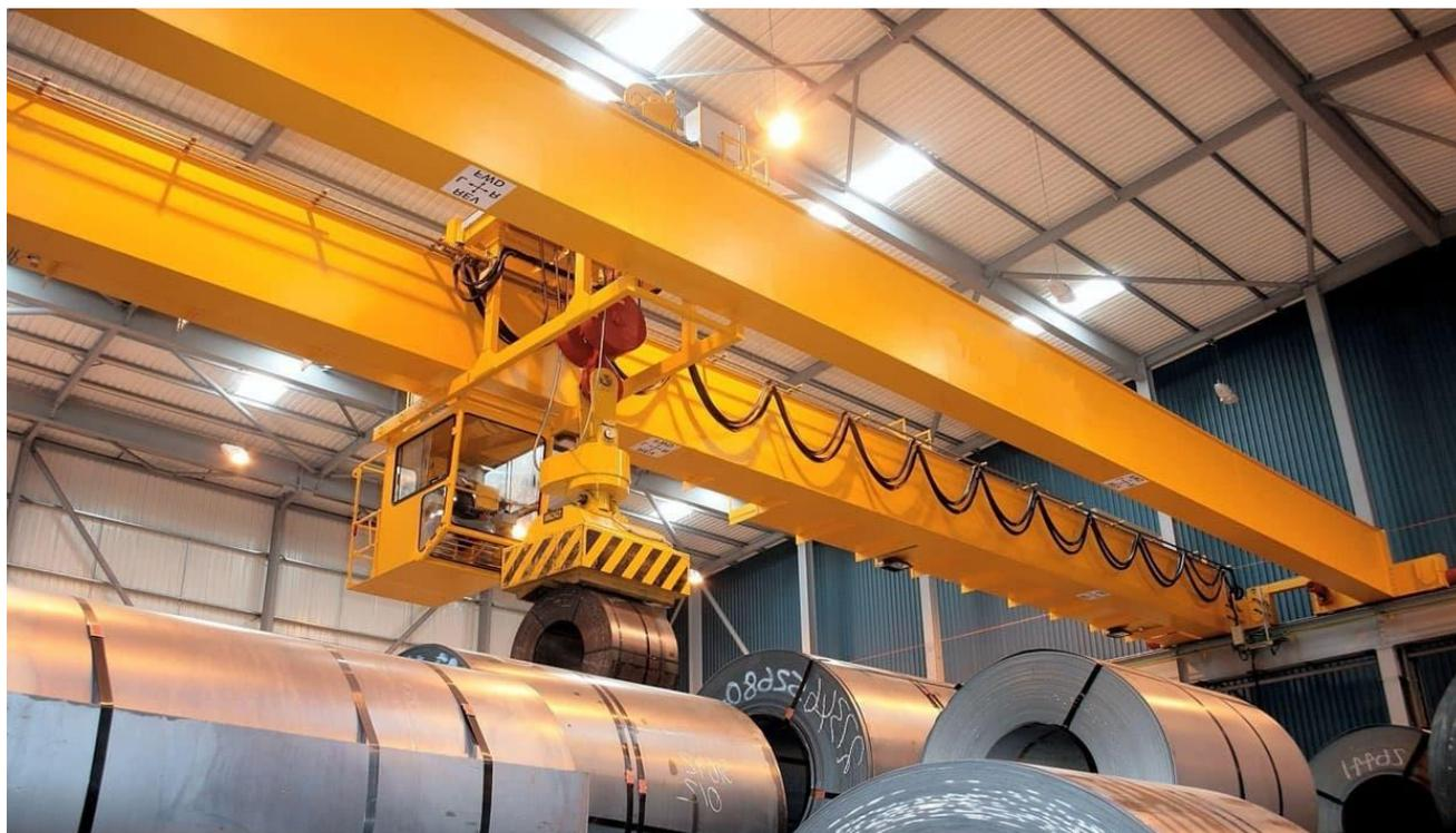
Рисунок 2.27 – Кран мостовой П-13-Г Q=5 т
